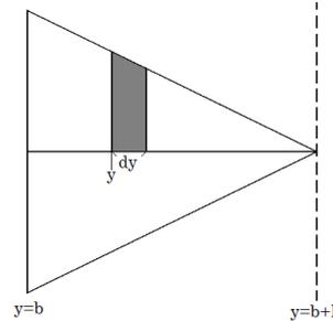
図のような回路の斜線の微小な面積を貫く磁束  $d\Phi$  は
